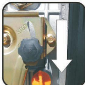
2 Posicione a alavanca de velocidade para a posição 'START'
